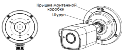
Рисунок 2-3 Установка камеры с монтажной коробкой
